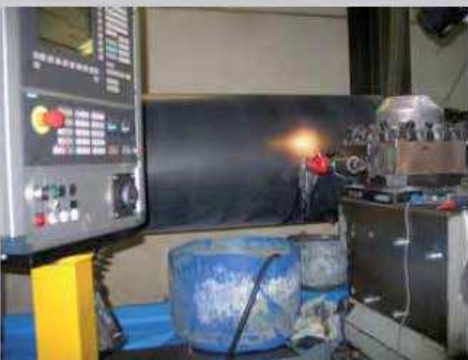
Elettroerosione su un tornio a controllo numerico. La regolazione dell'avanzamento avviene manualmente tramite il volantino
