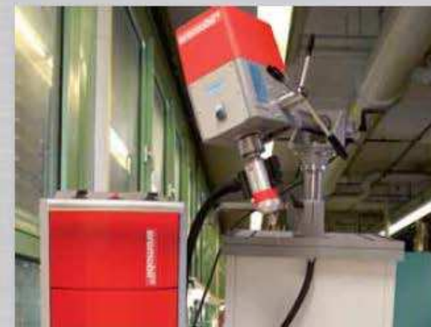
Elettroerosione in ciascuna posizione angolare o di grandi pezzi sull'unità di elettroerosione radiale
