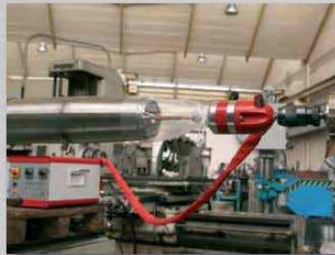
Elettroerosione orizzontale su un'alesatrice. Al posto della punta viene serrata nella macchina la testa oscillante dell'apparecchio di elettroerosione
