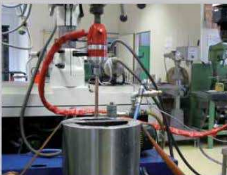
Maschi rotti in una camicia di acqua di raffreddamento, elettroerosione con avanzamento automatico
