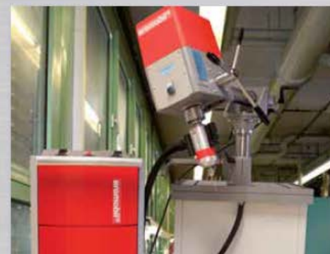
Elettroerosione in ciascuna posizione angolare o di grandi pezzi sull'unità di elettroerosione radiale
