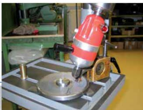
Elettroerosione di fori obliqui
